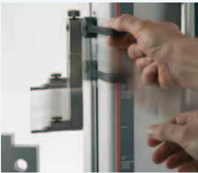
Рис. 1. Переместите измерительную каретку в направлении измеряемого объекта.
